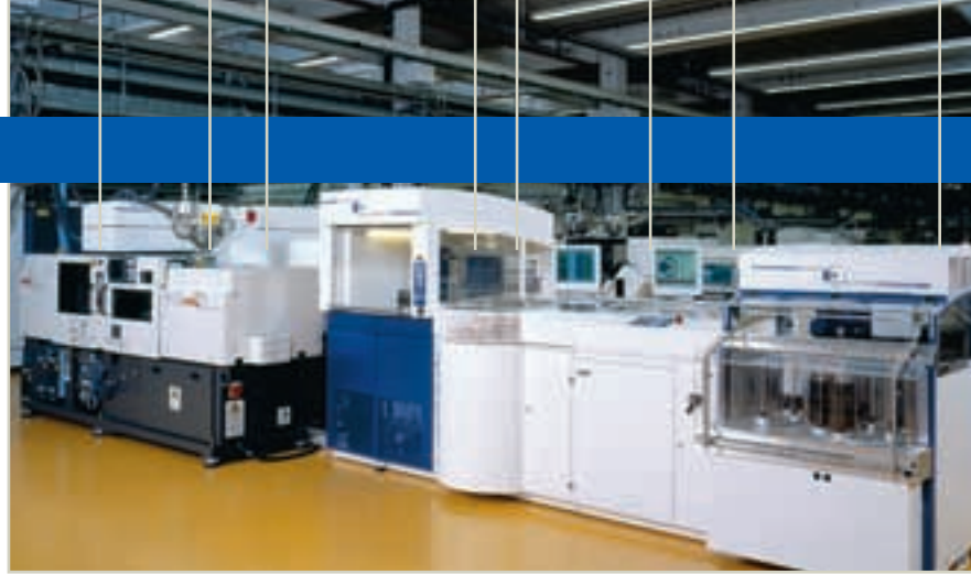
CD-R Replikationslinie STREAMLINE mit zwei EMOULD-Spritzguss- maschinen
