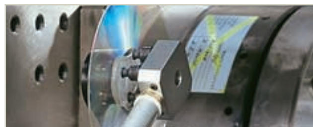
Sogenannte „Mould“ in einer EMOULD- Spritzgussmaschine
