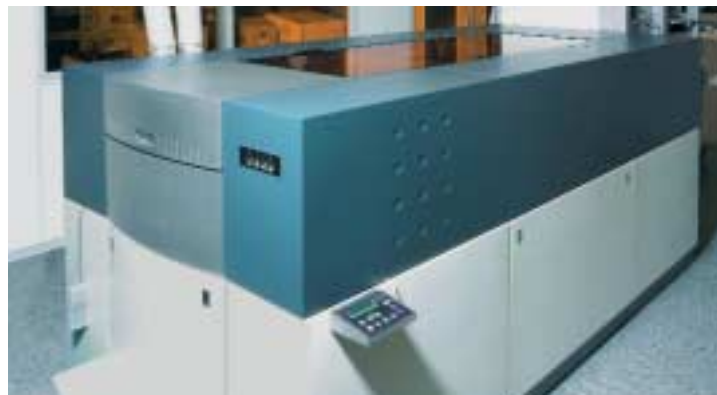
Deep UV - Mastering System für die 3. Generation Optical Disc – Blu-Ray im Philips Testlabor
