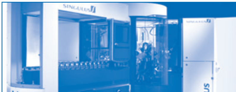
OPTICUS - Inline Beschichtungsanlage für Brillengläser
