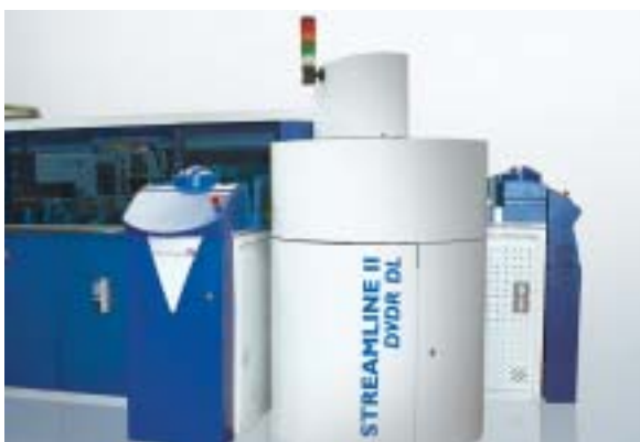
STREAMLINE II DVDR DL - Replikationslinie für Dual Layer DVDR
