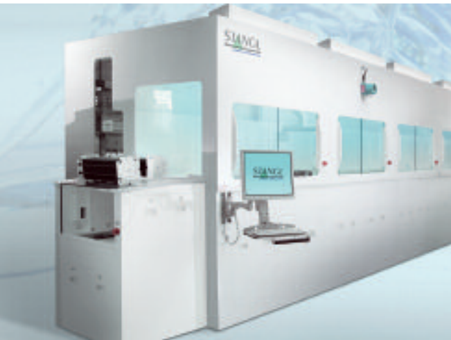
Nasschemische Reinigungsanlage von STANGL für kristalline Silizium-Solar-Zellen
