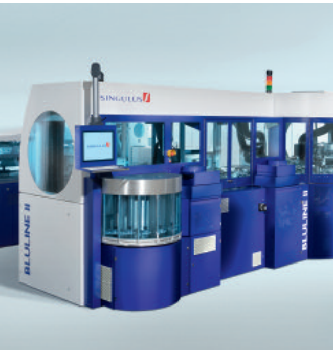
BLULINE II – neue Produktionsanlage zur Herstellung von Dual Layer Blu-ray Disc mit einer Speicherkapazität von 50 GB
