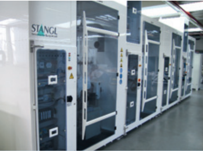
STANGL CIS/CIGS-Prozessanlage zur nasschemischen Behandlung in der Dünnschicht-Solartechnik
