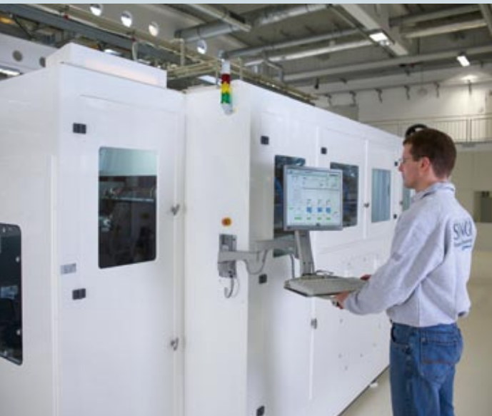
Anlage für die nasschemische Reinigung sowie für das Aufbringen von Barrierschichten bei flexiblen Dünnschicht-Solarzellen
