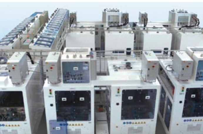
TENUIS Produktionsanlage für Barrierschichten in der Dünnschicht-Solartechnik
