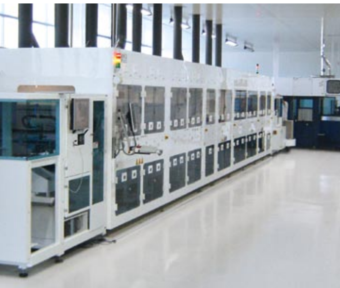
Teil eines Front-End Produktionssystems für Si-Solarzellen (Waferhandling, LINEA System kombiniert mit SINGULAR Anlage)
