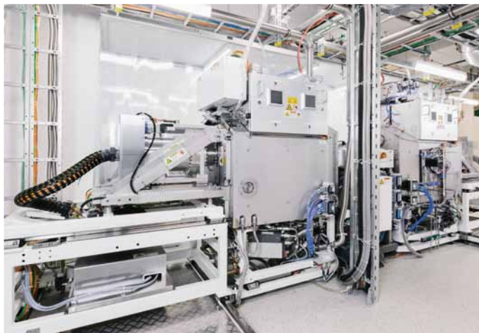
ROTARIS Vakuumbeschichtungsanlage für Anwendungsversuche (geliefert an die Universität Mainz)
