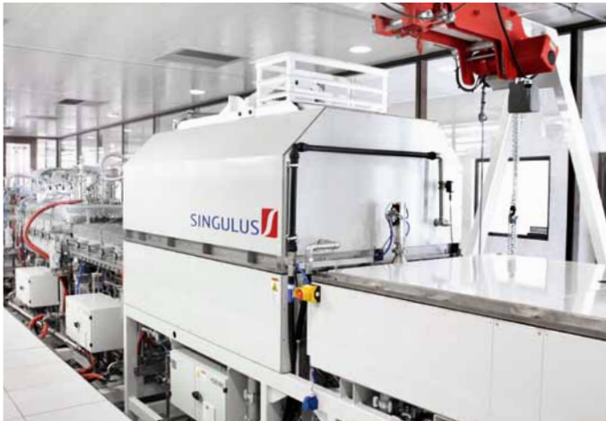
CISARIS Labor- Selenisierungsanlage (geliefert an PTiP Südafrika)
