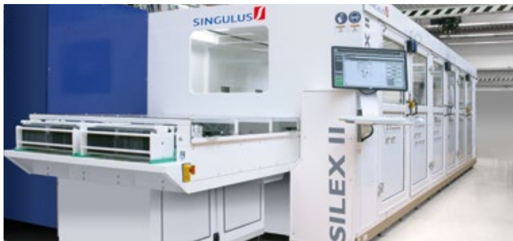
Prozessanlage für die nasschemische Behandlung von Heterojunction Solarzellen
