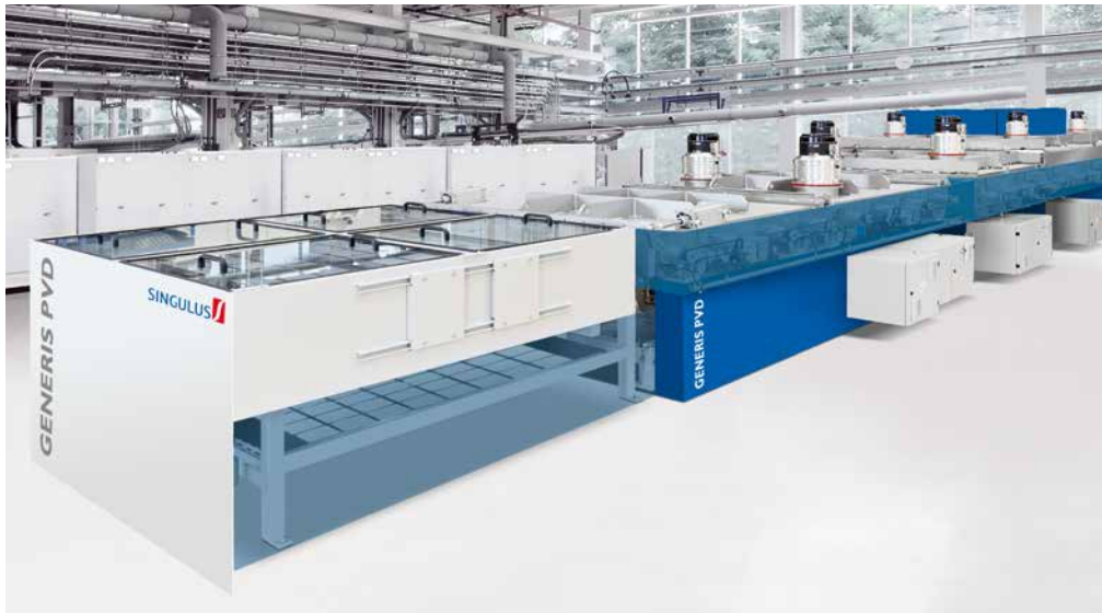
Kernkompetenz von SINGULUS TECHNOLOGIES: GENERIS PVD Vakuum-Beschichtungsanlage für Heterojunction Solarzellen
