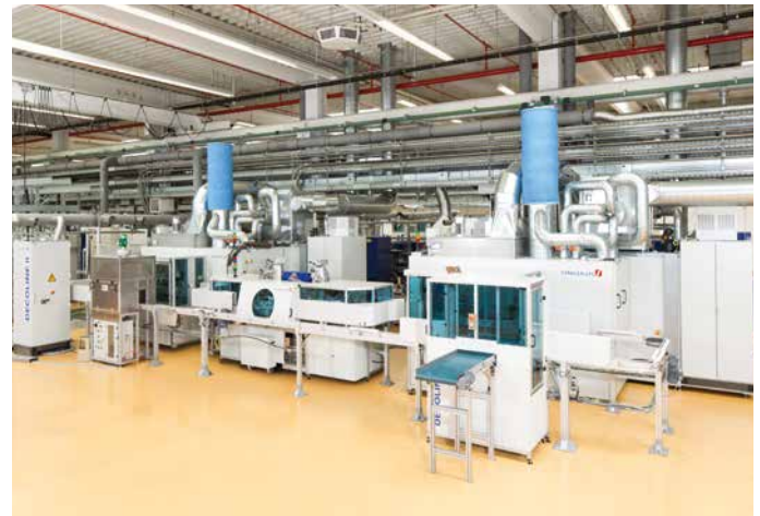
DECOLINE II – Inline-Beschichtungsanlage für 3D-Bauteile
