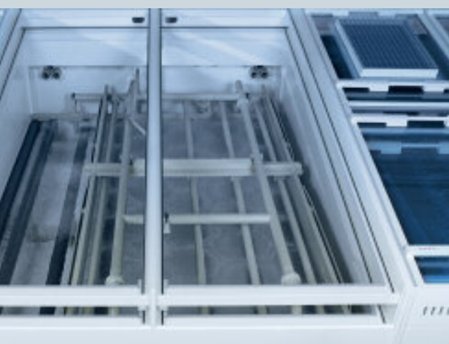
VITRUM – Inline Reinigungs- und Beschichtungsanlage für Solarglas
