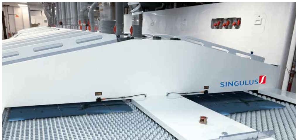
Inline-Anlage für nass- chemische Prozesse in der Solartechnik
